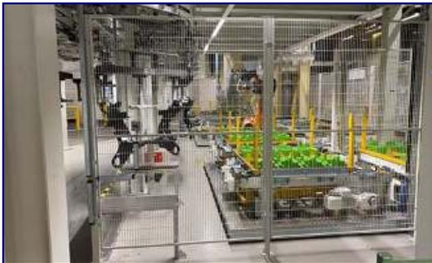
Der Transport der Achsträger durch die Anlage erfolgt mit Hilfe eines aus 5 Kettenkreisen bestehenden Power&Free-Systems. An der Aufgabestation werden die Achsträger mit Hilfe von Handlingsrobotern aus Transportboxen entnommen und an das P&F-System übergeben. Die Achsträger werden durch einen Maskierbereich in die Lackierkabine transportiert. Nach erfolgter Lackierung führt der Transportweg über eine Abdunstzone in den Trockner. Hier werden die lackierten Achsträger bei einer
